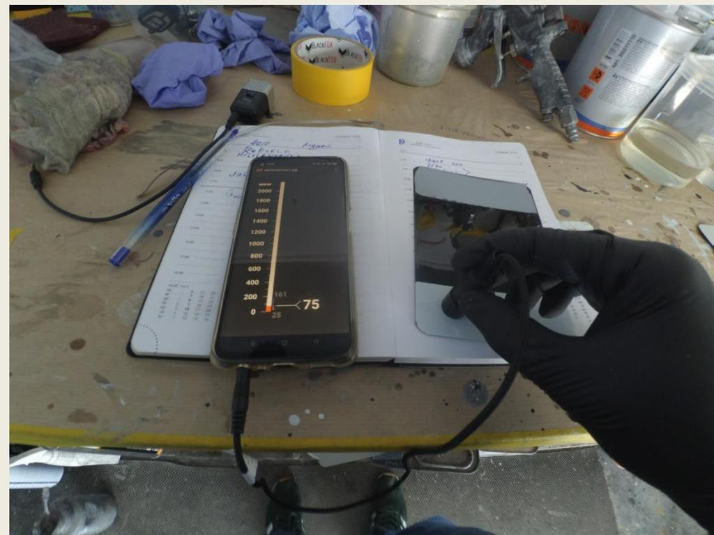
На панель израсходовали – 97гр. Готовой смеси. Толщина покрытия составила 55мкм. (с учетом толщины покрытия тест панели)
