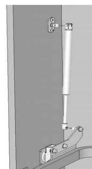
используя дюбеля эксцентрики поз.70, эксцентрики поз.69. Наклеить на упоры отбойники поз.6.
