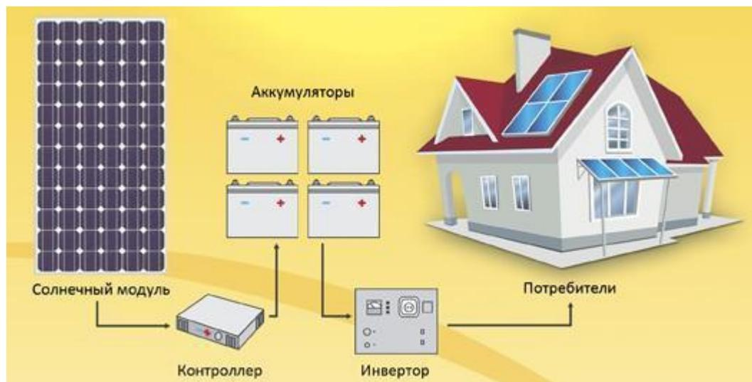
**Пожалуйста, соблюдайте последовательность подключения, другая последовательность подключения может привести к выходу из строя контроллера солнечных батарей.**
