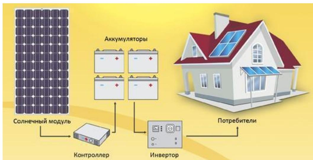
**Пожалуйста, соблюдайте последовательность подключения, другая последовательность подключения может привести к выходу из строя контроллера солнечных батарей.**
