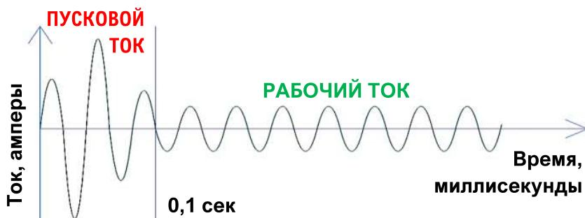
Пусковые токи необходимы для запуска, но несут с собой лишь негативные последствия, такие как перегрузка и перегрев электропроводки, прогорание плохо закрученных контактов, выход из строя электронных компонентов (конденсаторы, транзисторы, реле и др.).
