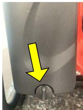
Снимите крышку воздушного фильтра.
