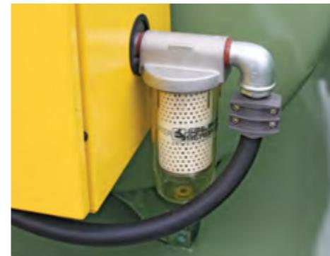
Топливный фильтр ES-FILTER изготовлен компанией Emiliiana Serbatoi; он совместим с ДИЗЕЛЬНЫМ ТОПЛИВОМ, БЕНЗИНОМ И ЭТАНОЛОМ. Имеет водоотделяющую функцию.
