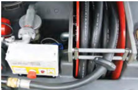
Электрический щит и катушка с пружинным приводом.
