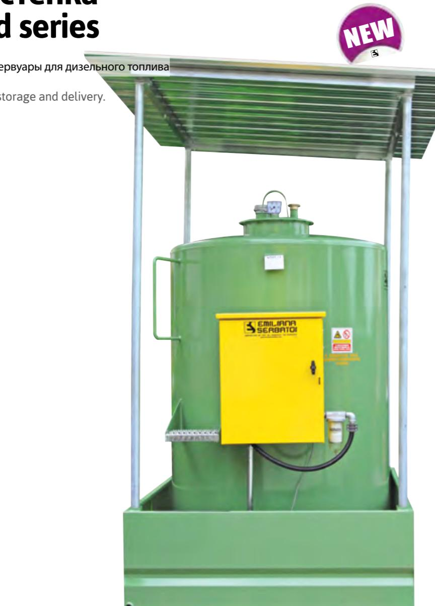
Вертикальные горизонтальные резервуары (кроме мод. 490: вертикальные резервуары) имеют выпуклые днища, изготавливаются из каландрированной листовой углеродистой стали S 235 JR в соответствии со стандартами UNI EN 10025; всестыки выполнены методом дуговой сварки под флюсом, наружная поверхность покрыта слоем антикоррозионной грунтовки и финишным слоем зелёной краски; испытаны на герметичность.
