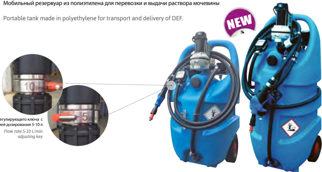
Резервуары из полиэтилена с электронасосом на 12 или 24V, производительностью 30 л/мин, 4 м кабелем с зажимами для аккумулятора, автоматическим пистолетом ZVA подходящим для заправки автомобилей (с функцией дозирования 5-10 л с помощью регулирующего ключа) и 3 м шлангом из EPDM
