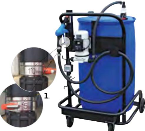
Тележка с насосом 220 V, производительностью 30 л/мин, 4 м кабелем с зажимами для аккумулятора, автоматическим пистолетом ZVA подходящим для заправки автомобилей с функцией дозирования 5-10 л с помощью регулирующего ключа) и 3 м шлангом из EPDM. В наличии также электронный расходомер модель K24.
