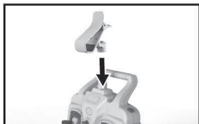
Выровняйте держатель мобильного устройства и установите его на антенну передатчика
