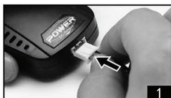
1. Подключите балансировочный разъем аккумулятора к зарядному устройству.
