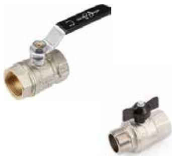
Шаровые краны серия 7S00 (стандартный проход) и 7100 (полнопроходные). Подходят для систем отопления и кондиционирования воздуха, для санитарных установок и установок сжатого воздуха. Клапаны имеют резьбовые концы В/В, Н/В ИЛИ Н/Н. Они доступны с рычагами и / или бабочками из алюминия или с пластмассовым покрытием.
