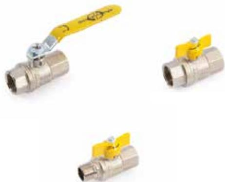
Полнопроходные шаровые краны серия 7400 для газа. Они изготовлены в соответствии со стандартом UNI EN 331. Они подходят для транспортировки и перехвата газов типа 1<sup>^</sup> / 2<sup>^</sup> / 3<sup>^</sup> и для установок низкого и среднего давления. Клапаны имеют резьбовые соединения В/В и Н/В. Они доступны со стальными рычагами с пластмассовым покрытием и с окрашенными алюминиевыми бабочками.
