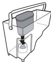
**17** Вставьте фильтр AquaClean в вертикальном положении в соответствующий разъем. Нажмите на фильтр AquaClean, чтобы он опустился вниз до упора. Для обеспечения оптимальной работы убедитесь, что фильтр плотно зафиксирован, а уплотнительный слой находится в правильном положении.
