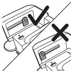
*Примечание. Перед тем, как установить носик для молочной пены на верхнюю часть сосуда, необходимо установить в нужное положение фиксатор, расположенный в верхней части. Если этот фиксатор расположен неправильно, вы не сможете установить носик для молочной пены на верхнюю часть сосуда.*
