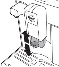
Эта кофемашина предназначена для разлива различных видов кофе в чашки и стаканы разных размеров. Высоту носика выхода кофе в зависимости от размера чашки или стакана можно настроить, сдвинув его вверх или вниз.
