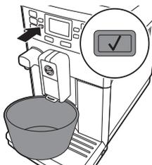
**12** Поставьте чашку под носик для подачи горячей воды. Нажмите кнопку ОК, чтобы начать цикл заполнения водой. Машина начнет подачу горячей воды.
