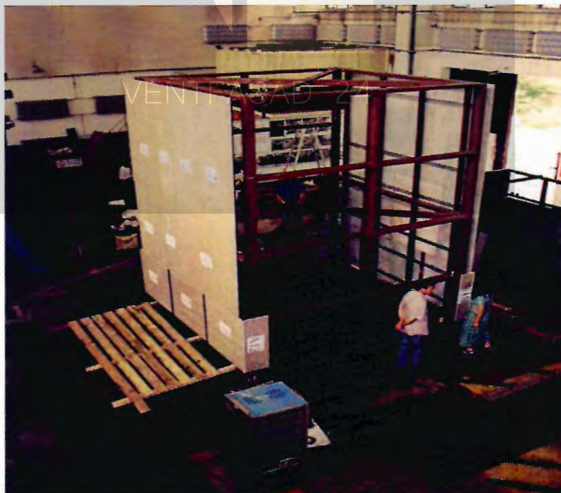
Рисунок 3.13 Общий вид испытательного стенда для динамических исследований конструкций НФС (снимок сделан одним из авторов отчета во время посещения НИЦ фирмы «Fischer»)
