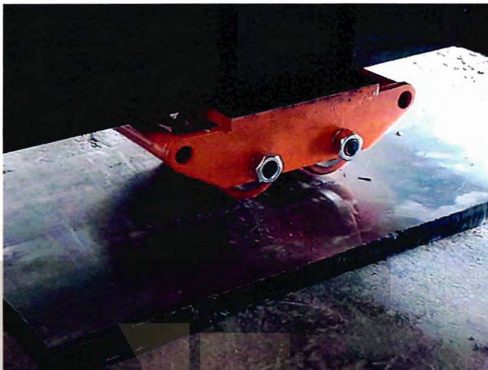
Рисунок 2.1 Общий вид опорных подвижных катков.
