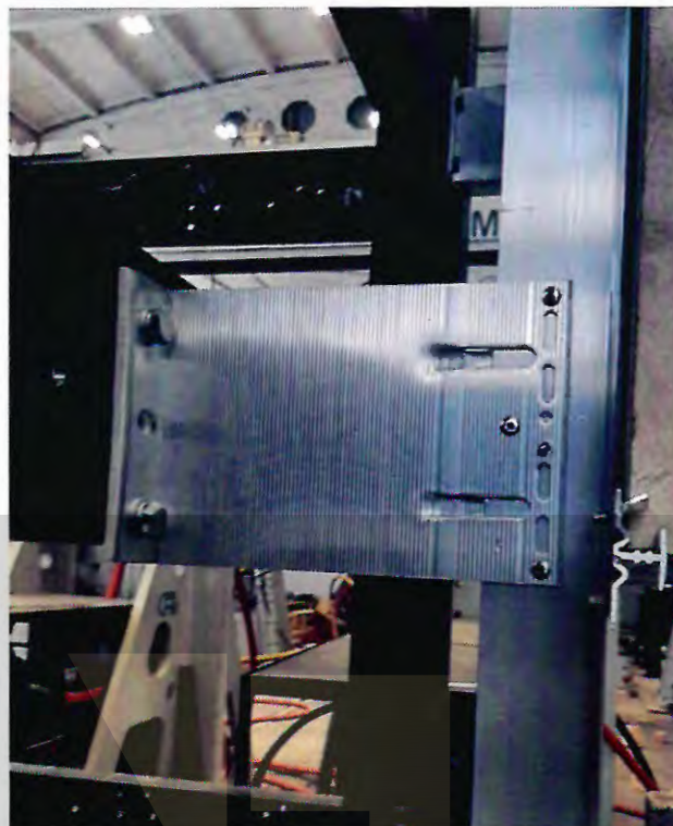
Рисунок 1.4 Узел крепления направляющих к кронштейну и кронштейна – к стенду.
