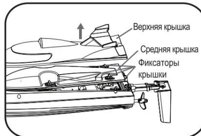
1. Поверните фиксаторы крышки лодки, возьмите верхнюю крышку и среднюю крышку лодки.
