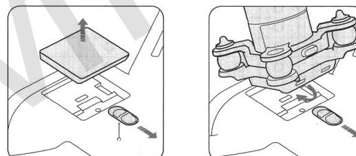
Передвинув фиксатор, снимите защитную панель слота
