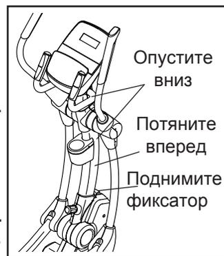
Затем поднимите ручку переднего стабилизатора так, чтобы эллипсоид начал опираться на колеса. Аккуратно передвиньте эллипсоид в нужное место, а затем опустите его на пол.
