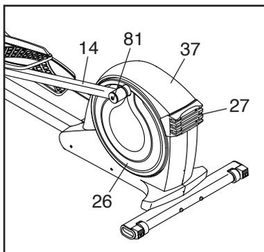
Удалите четыре винта М4 х 16мм (не показаны) из большой подножки (27), а затем снимите большую подножку. Удалите два винта М4 х 16мм (не показано) из защитного кожуха (37), и используя плоскую отвертку, подцепите защитный кожух и снимите его. Затем снимите диск педали (26) с эллипсоида.
