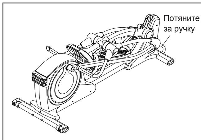
Когда вы закончите передвигать тренажер, поднимите стойку в вертикальное положение и закрутите ручку стойки.
