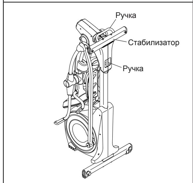
Чтобы опустить эллипсоид для использования, сначала возьмитесь одной рукой за ручку на раме и придерживайте передний стабилизатор другой рукой. Затем потяните раму на себя и опускайте раму до тех пор, пока вы не дотянетесь до ручки на переднем стабилизаторе. Затем удерживая ручку переднего стабилизатора, опустите раму эллипсоида окончательно на пол.
