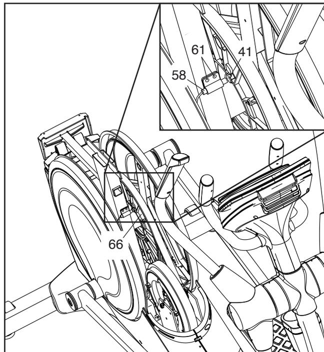
Затем выкрутите, но не выкидывайте два обозначенных винта М4 х 16мм (61). Немного переместите геркон (58) от или к магниту (41). Затем закрутите обратно винты М4 х 16мм.
