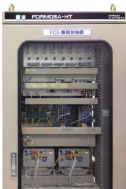
Рисунок 2. Система FORMOSA-FX со встроенным компьютером NEXCOM NISE-3660 в качестве PCY контроллера.
