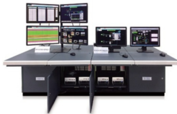
Рисунок 1. PCU FORMOSA-FX со встроенным компьютером NEXCOM NISE-3660 в качестве MMI.
